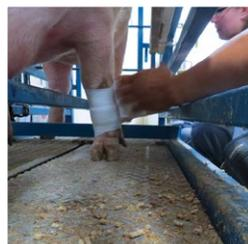
Installation d'un accéléromètre sur le membre arrière d'une truie. Source : Université du Manitoba
